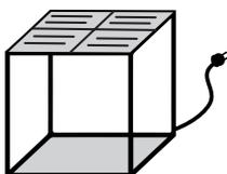
La version **Solaire** autoproduit toute ou une partie de son énergie selon la puissance consommée des équipements. Elle peut être raccordée au réseau électrique (pas de batterie) ou autonome et sans raccordement au réseau (avec batteries).
